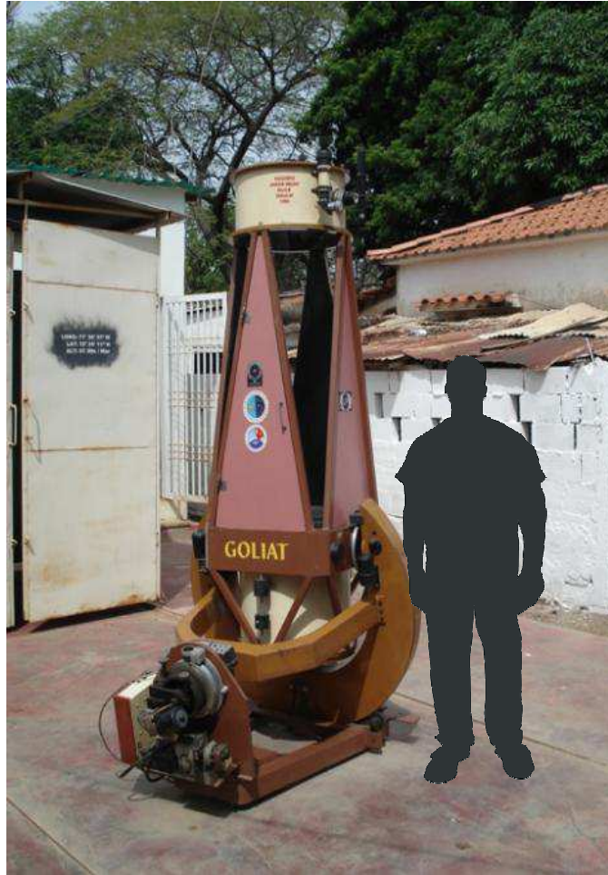
Telescopio Coulter-Maloni 0,45 m f/4.4
